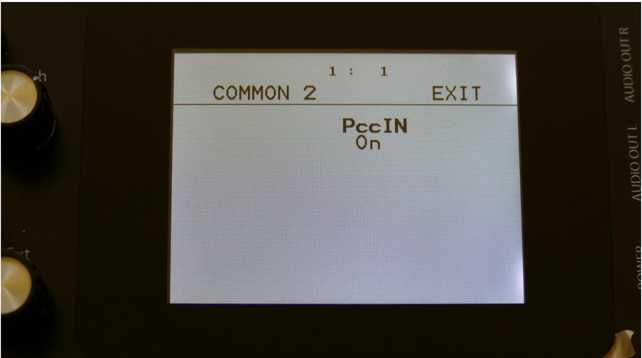
On this page, switch the PccIN parameter (Parameter CC Input) to On.
